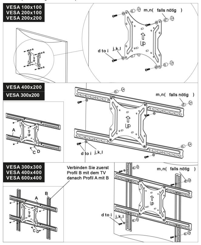
Achten Sie bei der Montage der Platte auf die korrekte Ausrichtung (oben), damit Sie später den TV richtig herum mit dem Arm verbinden können. Sollte Ihr TV-Gerät eine gewölbte Rückseite haben, verwenden Sie bitte die mitgelieferten Abstandshalter.
