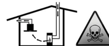
Gefahrloser Betrieb ist möglich, wenn der Unterdruck im Aufstellraum der Feuerstätte 4Pa (0,04mbar) nicht überschreitet. Dies kann erreicht werden, wenn durch nicht verschließbare Öffnungen, z.B. in Türen, Fenstern, in Verbindung mit einem Zuluft-/Abluft-Mauerkasten oder durch andere technische Maßnahmen, die zur Verbrennung benötigte Luft nachströmen kann.
